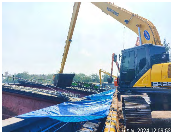
รูปที่ 2.2-13 การตัดถ่านหินไม่ให้ล้นบุงกีเพื่อป้องกันการฟุ้งกระจายของฝุ่นละอองขณะขนถ่ายและป้องกันการร่วงหล่นของถ่านหิน
