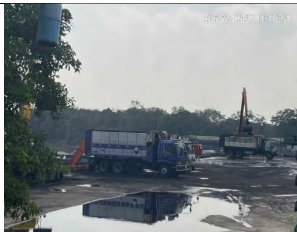
รูปที่ 2.2-13 การตัดถ่านหินไม่ให้ล้นบุงกีเพื่อป้องกันการฟุ้งกระจายของฝุ่นละอองขณะขนถ่ายและป้องกันการร่วงหล่นของถ่านหิน
