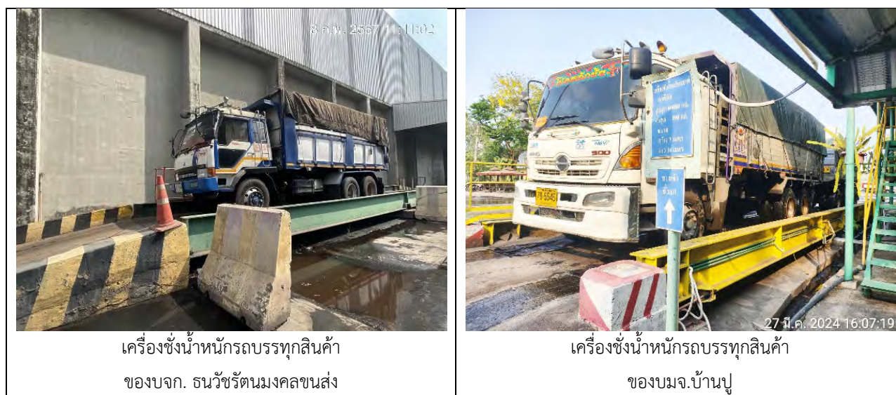
รูปที่ 2.2-31 เครื่องชั่งน้ำหนักรถบรรทุกสินค้า
